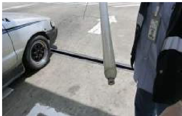
Fotografía 15-16: Verificación de producto en fase libre en el pozo de monitoreo. No se percibió olor a combustible en el día 29 de julio de 2020.
